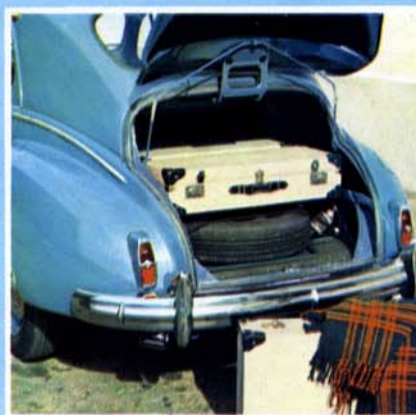
Le coffre AR comporte un logement indépendant pour la roue de secours qui peut être extraite sans déplacement des bagages.
