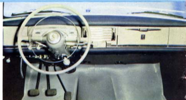
Planche de bord de sécurité garnie de caoutchouc mousse. Thermomètre et montre au tableau de bord.
